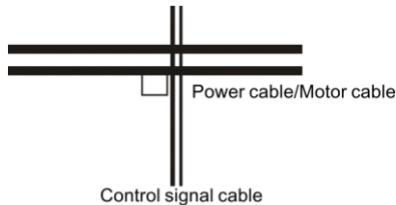
*Fig. 3-16 orthogonal wiring*
